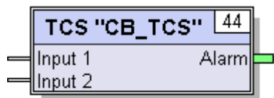
Slika 5.69: Funkcijski blok kontrole izklopnih tokokrogov
